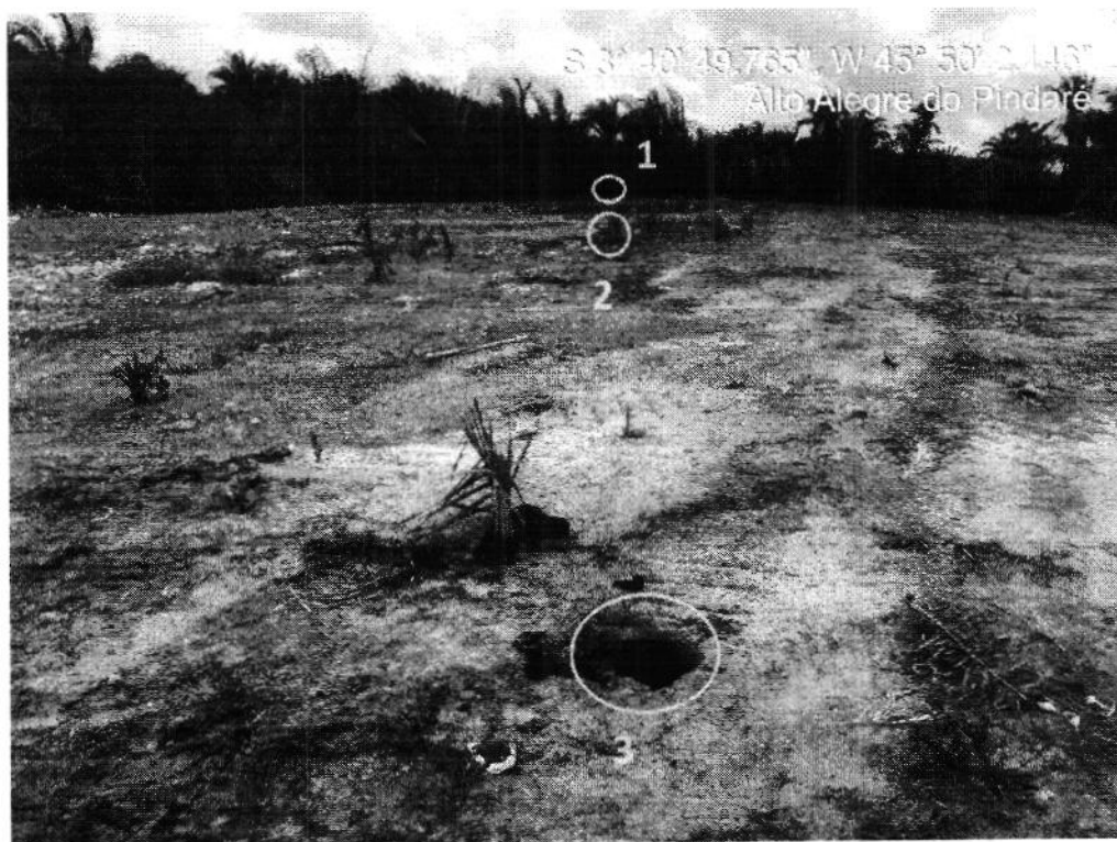
Figuras 8 e 9 – Vistas dos pontos de sondagem realizados na aérea do terreno do aterro sanitário em estudo.
